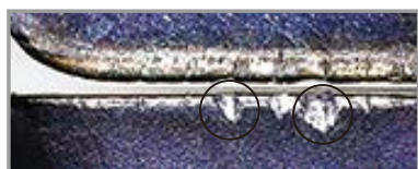
Vznik tepelných trhlin
